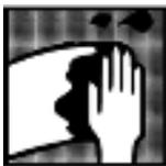
Nettoyer la surface à l'aide du dégraissant Genclean S241 pour éliminer la contamination avant l'application de la couche de finition.
