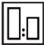
Il rapporto di miscelazione è 1 parte di Hydrobase™ Basecoat e 10% - 30% di WS20 Demineralized Water (Normal) o Hydrobase™ De-mineralized Water (Slow) WS10. Viscosità ottimale 22 - 24 sec/DIN4mm/ 20°C
